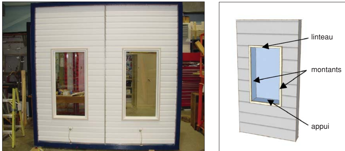
Figure 2. (a) Ensemble d'essai mur-fenêtre; (b) Diagramme d'ensemble mur-fenêtre montrant l'emplacement des détails de l'interface mur-fenêtre
